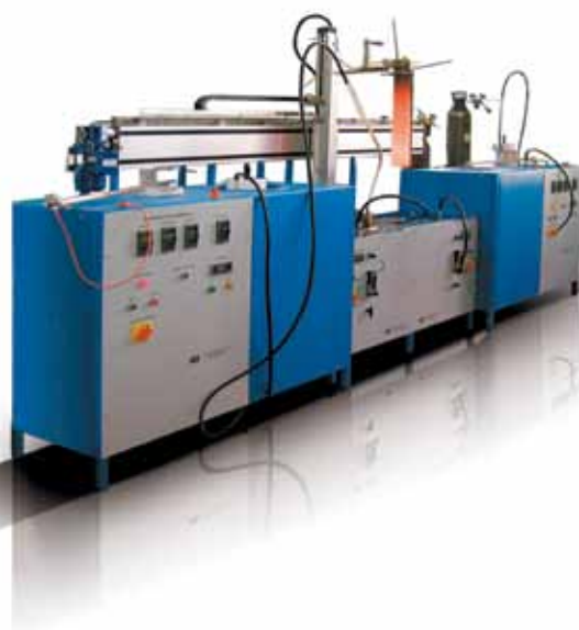
Рисунок 5. Двойная установка для определения показателей CRI/CSR
